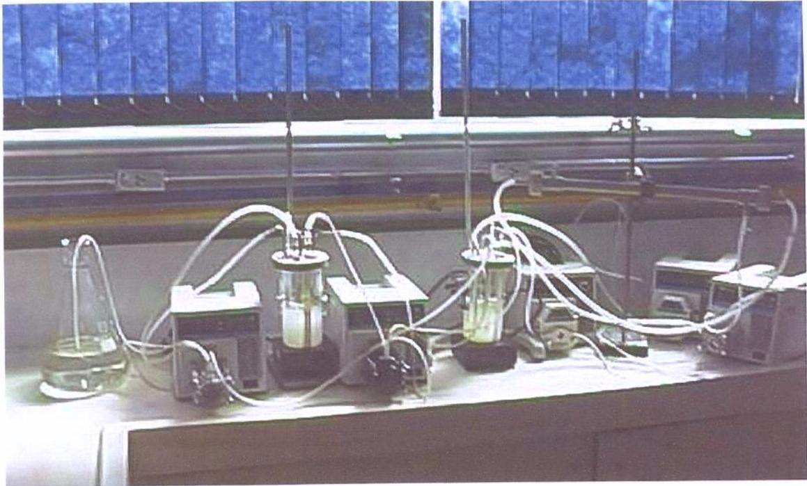
Figura 6.2: Fotografia do sistema em duplo estágio para produção de dextrana em operação.
