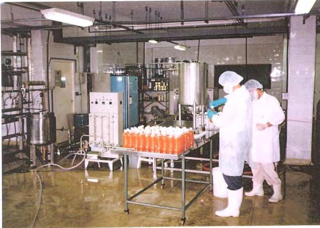
**FIGURA 7** - Vista da planta piloto utilizada no processamento da bebida isotônica, composta por trocador de calor a placas (ao centro) e tanques para elaboração do produto (à esquerda) e envase (à direita).
