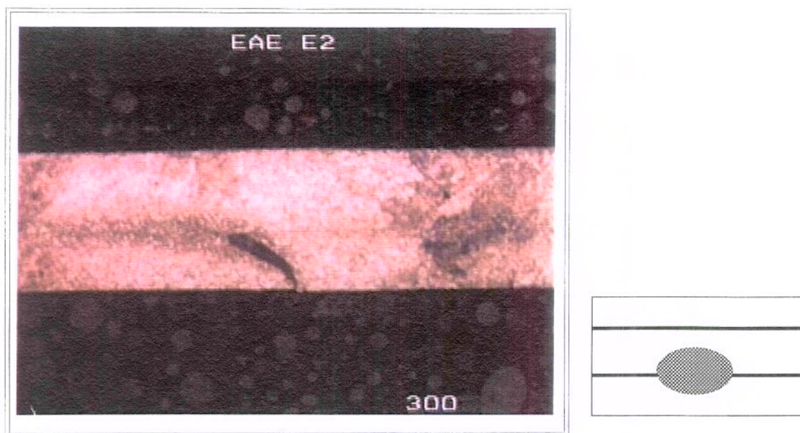
FIGURA 8. Fotomicrografia obtida em sistema My Scope operando com aumento de 300 vezes da seção longitudinal da lata EA para ervilha na posição entrada, mostrando a ocorrência de vírgula.
