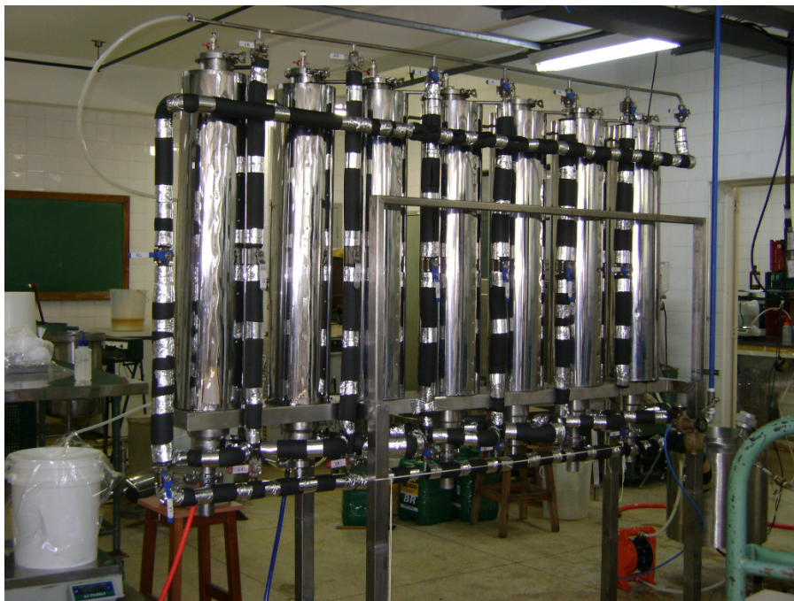
Figura 6 – Bateria de extração
