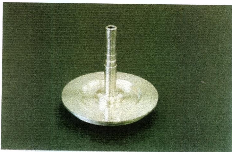
Figura 3.8-Sistema de placas Paralelas pq 30mm do Reômetro Haake Rotovisco RV-20.
