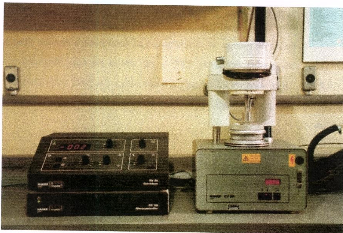
Figura 3.3-Reômetro Haake Rotovisco, modelo RV - 20.
