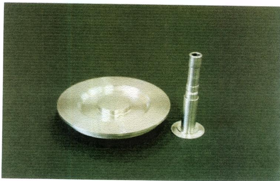
Figura 3.9-Sistema de placas Paralelas pq 30mm do Reômetro Haake Rotovisco RV-20.
