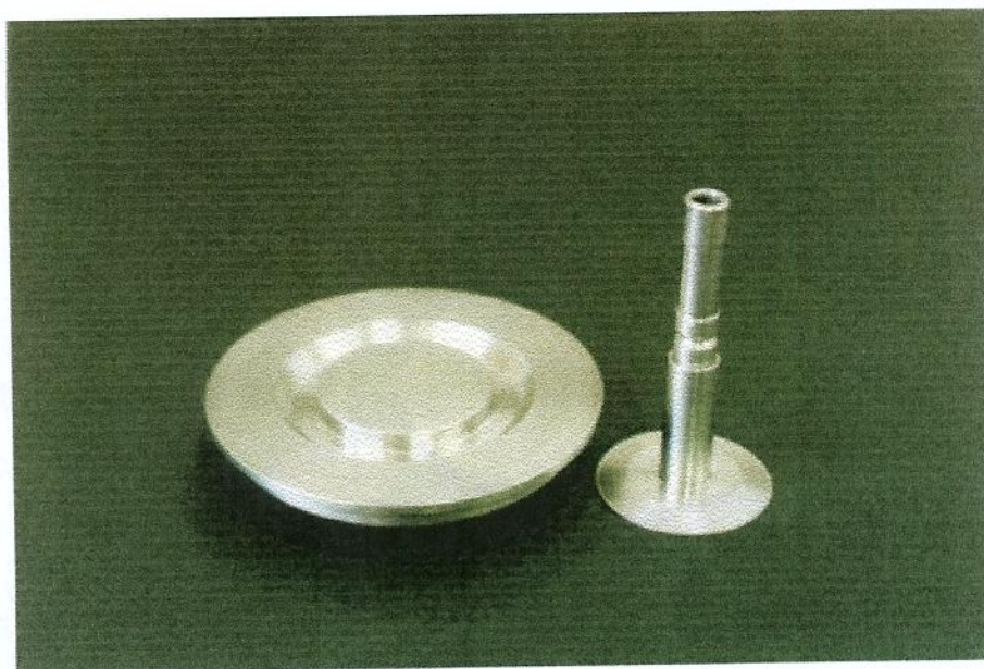
Figura 3.7-Sistema de placas Paralelas pq 45mm do Reômetro Haake Rotovisco RV-20
