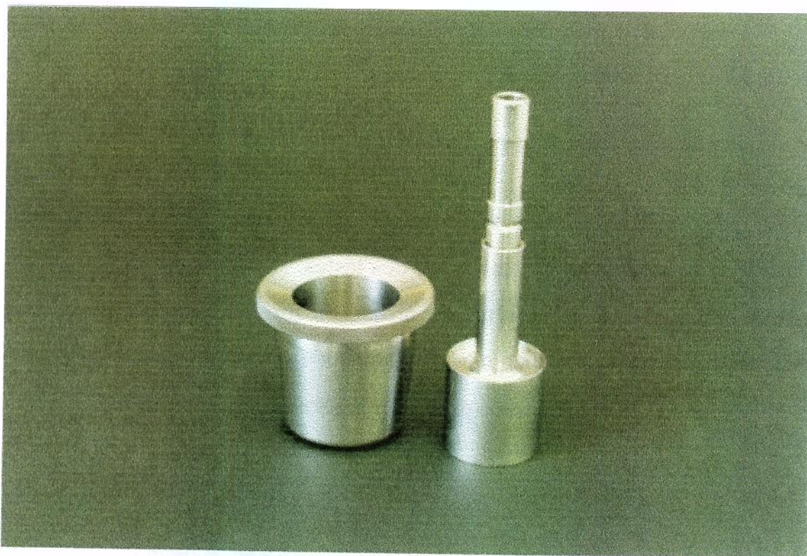
Figura 3.5 - Sistema de medida ZA-30 - Reômetro Haake Rotovisco
