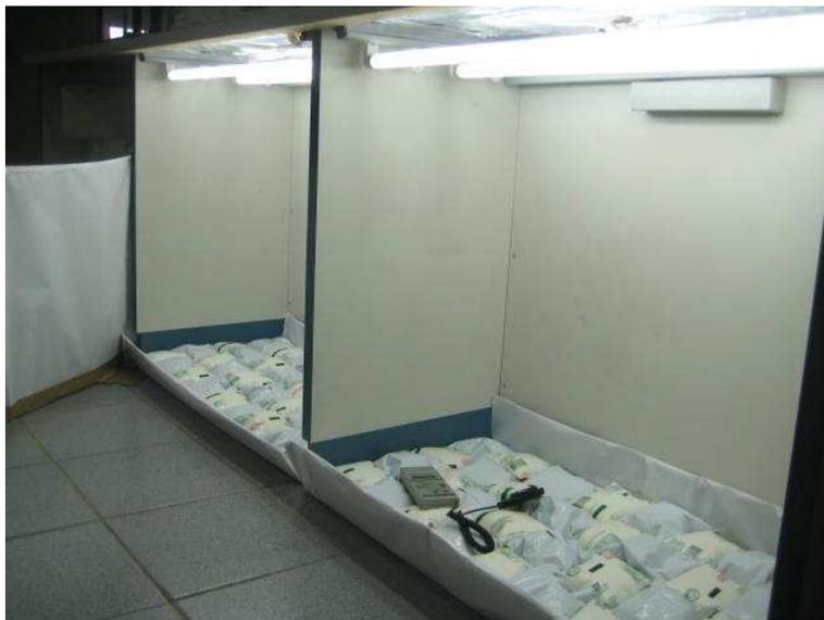
**Figura 3** - Câmaras de luz com amostras de leite longa vida e o luxímetro digital.
