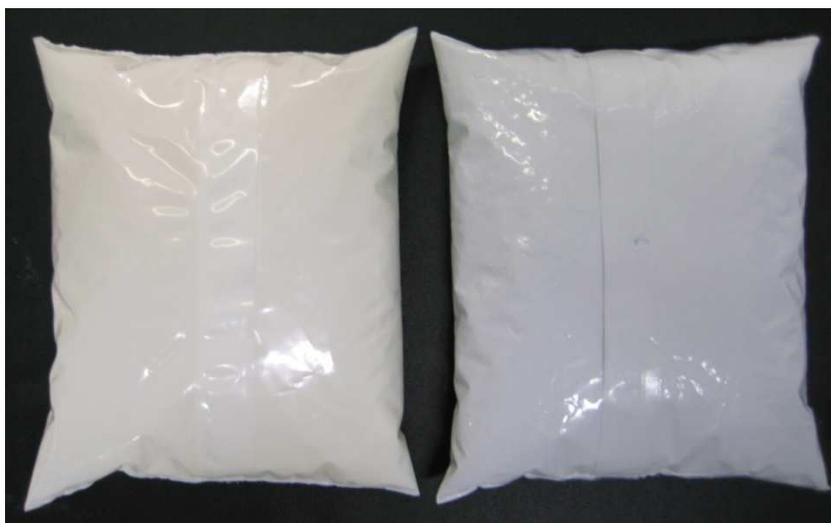
**Figura 2** - Embalagens de polietileno de baixa densidade pigmentado com dióxido de titânio (PEBD) e do laminado multicamada (LMC).
