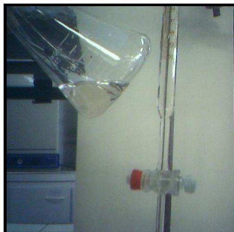
Figura - Anexo 3. Comparação entre a solução final titulada e a amostra presente na bureta. A coloração é muito próxima, servindo como parâmetro do final da reação.
