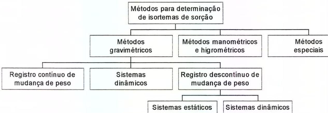
Figura 2.3 – Métodos para determinação de isotermas de sorção segundo GÁL (1975)
