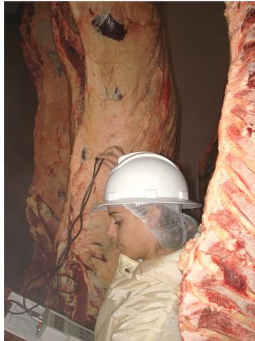
**Figura 7.** Medição do pH e temperatura das carcaças
