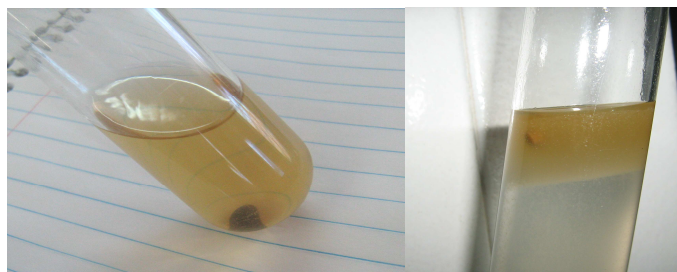
Figura 18 - Derivatização da amostra de cera de cana-de-açúcar segundo metodologia descrita por Lepage e Roy (1986)
