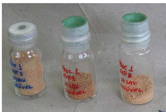
Figura 9 - Concentrado de álcoois graxos da cera de cana, resultantes das 3 extrações com álcool etílico a quente (Ensaio 3). Da esquerda para direita: extração 1, 2 e 3.
