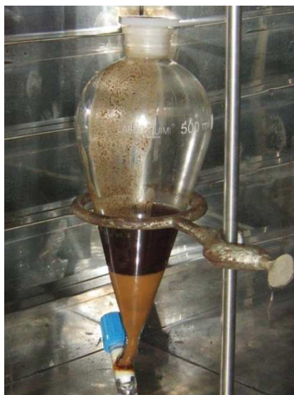
Figura 4 - Etapa de separação das frações de ácidos (inferior) e álcoois (superior) graxos, utilizando funil de separação em estufa com aquecimento. Ensaio 5.
