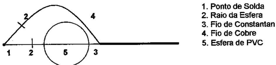
FIGURA 3.1. Desenho esquemático da fixação do termopar na esfera.
