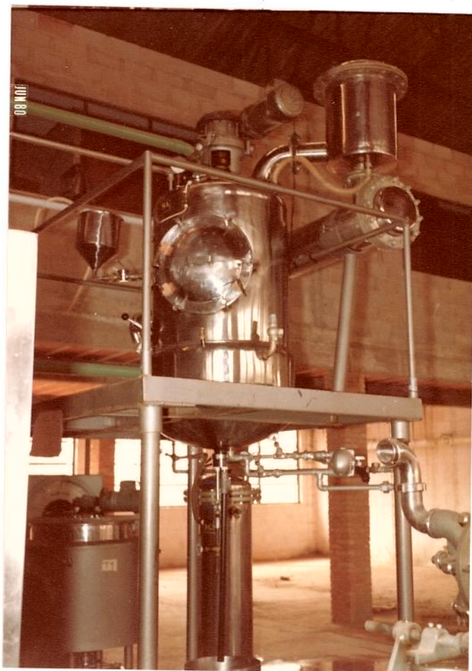
FIGURA 7 - Conjunto evaporador a vácuo ICMA, da Planta Piloto FEAA-UNICAMP, convenientemente adaptado.
