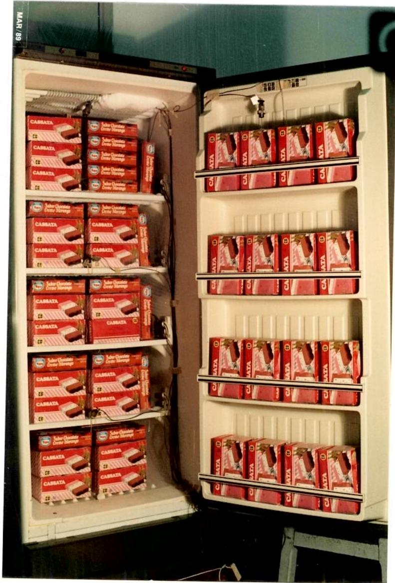
FIGURA 3.4. Vista interna do congelador acomodando uma carga de 75kg.
