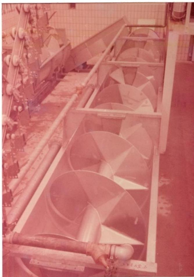
Fig. 3.3 - Vista interna de um resfriador por imersão tipo rosca-sem-fim.
