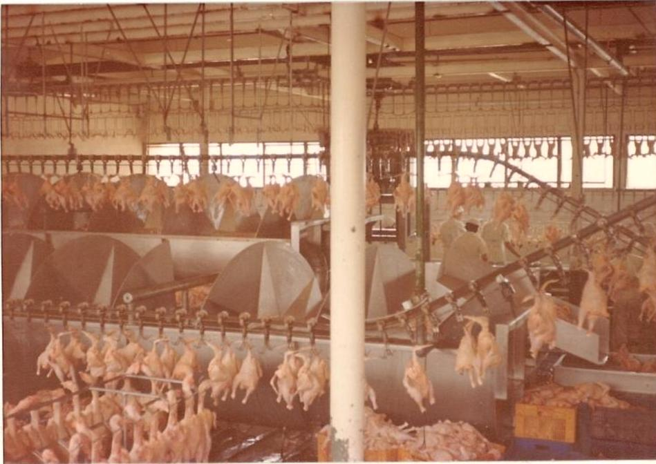
Fig. 3.2 - Vista parcial do interior da planta de processamento. Em primeiro plano tem-se o sistema de resfriamento por imersão e, ao fundo, o cortador de pés e linha de evisceração, respectivamente.
