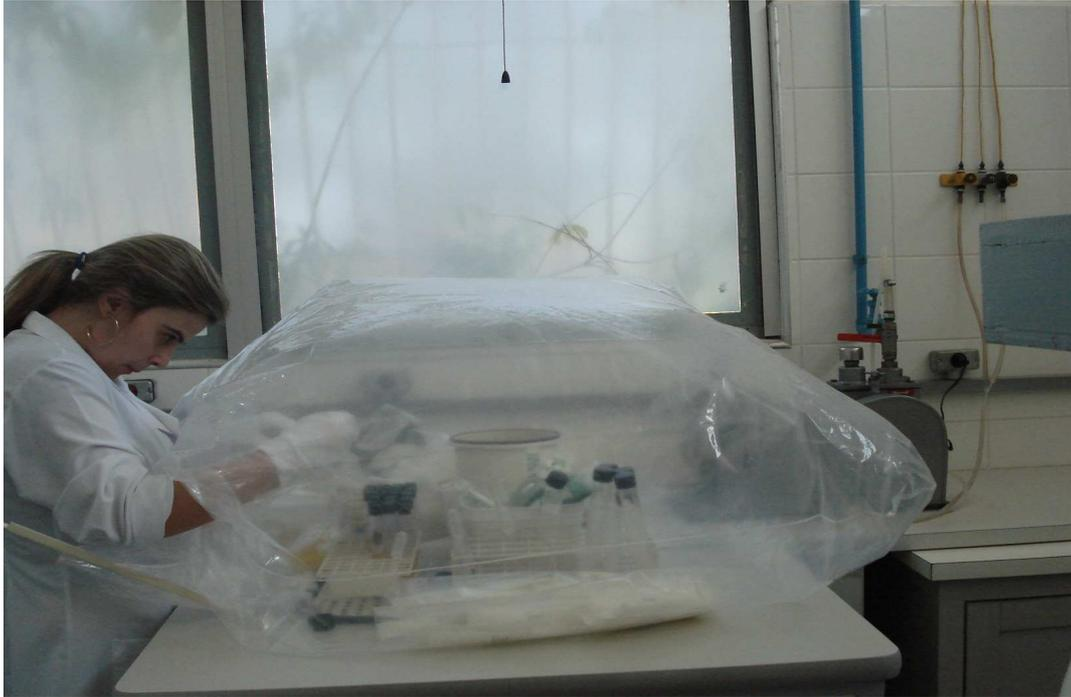
**Figura 5.** Sistema de anaerobiose Glove bag™ modelo X-37-27
