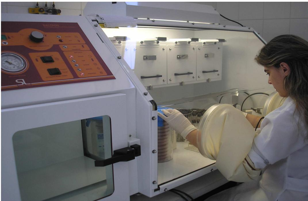
**Figura 6.** Câmara de anaerobiose Shell lab™ modelo Bactron II Chamber
