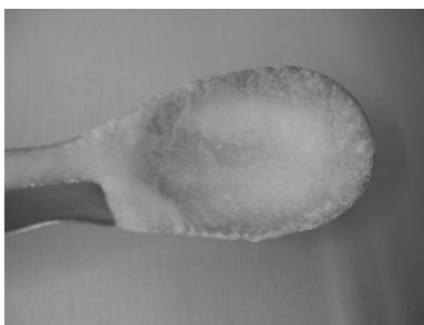
Figura 4.6. Aparência da emulsão homogeneizada a 200 bar /1 passagem.
