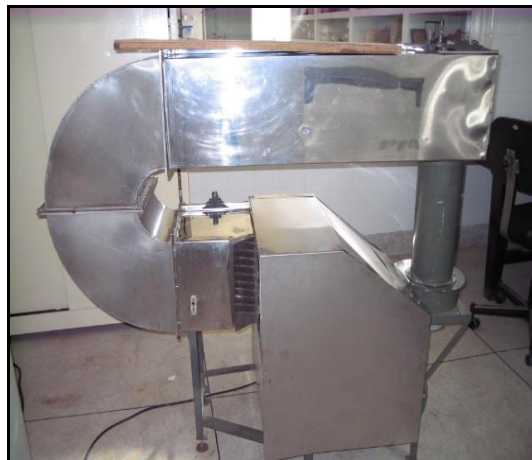
Figura 4.3.2 Desumidificador A (Parte Posterior).
