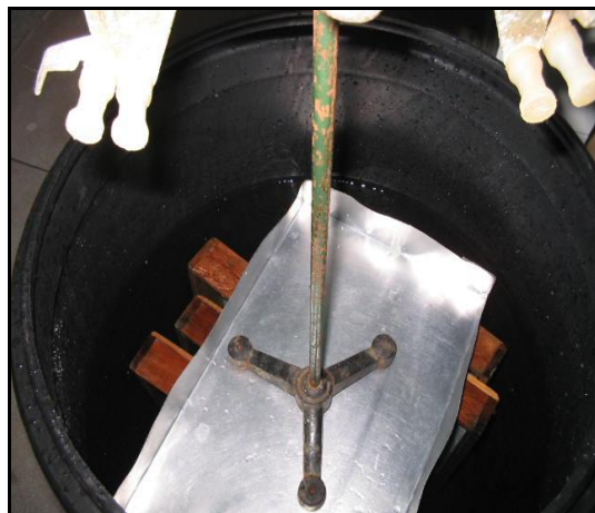
Figura 4.2.12 Higienização dos coletores.
