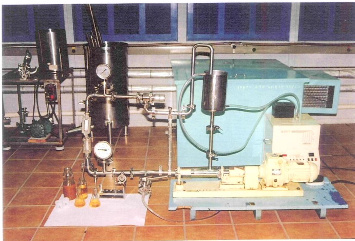
FOTO 1 - Vista geral do equipamento piloto de filtração tangencial utilizado na clarificação dos sucos de maçã, uva e limão
