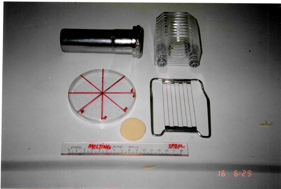
**Figura 3.2.12.1. Instrumentos utilizados para determinar a capacidade de derretimento**
