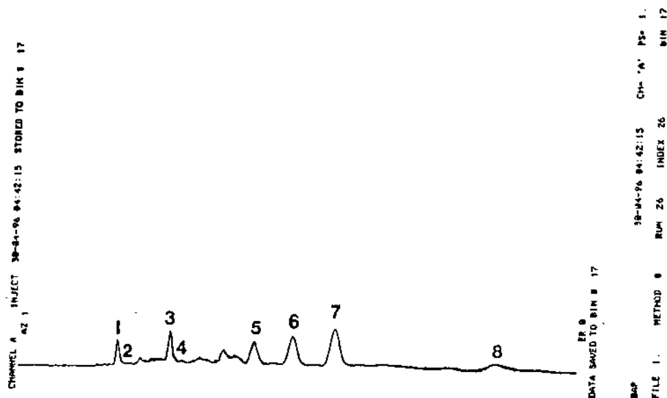
ANEXO 12- Cromatograma por CLAE de uma amostra de maionese. Condições: fase móvel acetonitrila: água (75:25), fluxo 1 ml/ml, detector de fluorescência, coluna C18 (ODS), 25 cm X 4,6 mm d.i., com partículas de 5 µm. Picos: 1=F, 2=P, 3=B(a)P, 4=Cr, 5=B(b)F, 6=B(a)P, 8=B(a,h)A.
