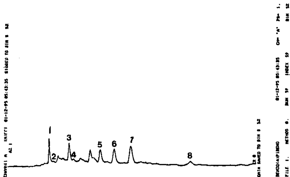
ANEXO 15- Cromatograma por CLAE de uma amostra de gordura vegetal. Condições: fase móvel acetonitrila: água (75:25), fluxo 1 ml/ml, detector de fluorescência, coluna C18 (ODS), 25 cm X 4,6 mm d.i., com partículas de 5 µm. Picos: 1=F, 2=P, 3=B(a)P, 4=Cr, 5=B(b)F, 6=B(a)P, 8=B(a,h)A.
