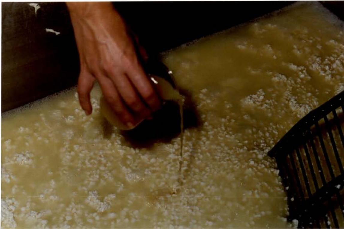
FIGURA 03: Adição da enzima Neutrase® previamente dissolvida em soro à massa dos queijos, durante a fabricação.
