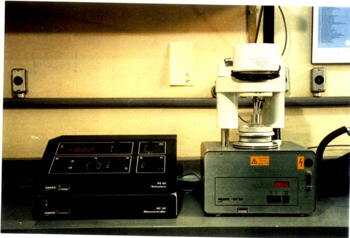
Figura 06 - Reômetro Haake modelo RV-20 com vista dos módulos de controle e dos suportes de sistemas de medição onde se vê inserido o sistema ZA-30.
