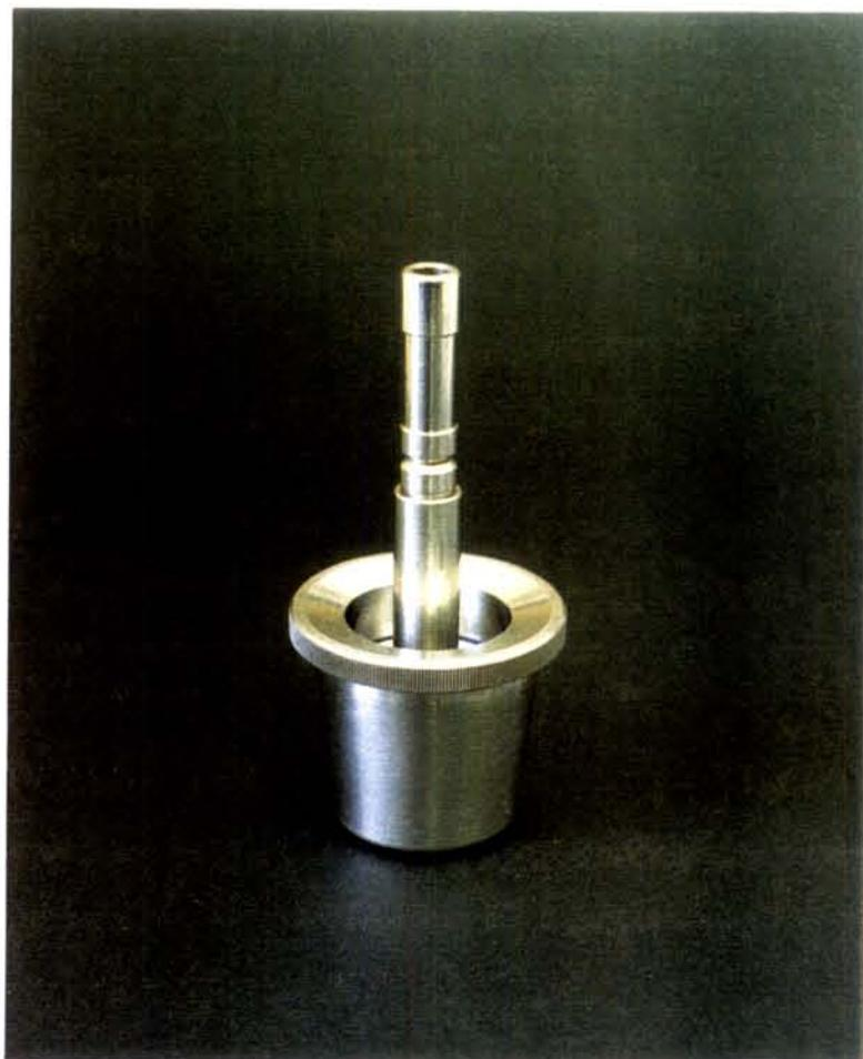
Figura 07 - Sistema de medição ZA-30 com vista do conjunto cilindro/copo.
