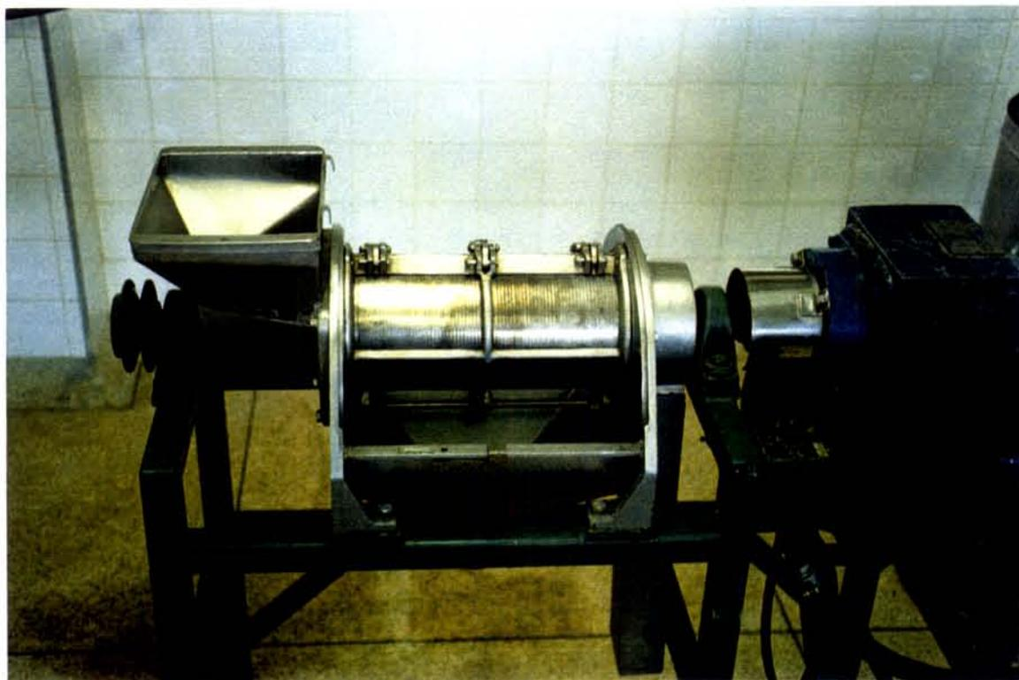
Figura 01 - Despoldadeira utilizada na obtenção dos sucos, com vista do cilindro de tela.
