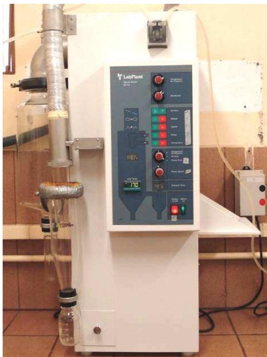
**Figura 3.2.** *Spray dryer* utilizado nos ensaios de secagem.
