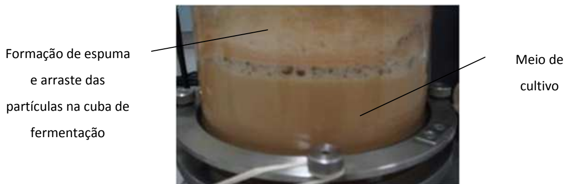
Figura I-4 - Formação de espuma durante a fermentação da linhagem Streptomyces sp. P20 em meio de cultivo de alta viscosidade, em reator de bancada.
