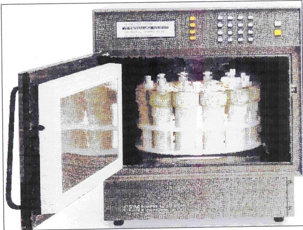
Figura 9 - Forno aplicador de microondas
