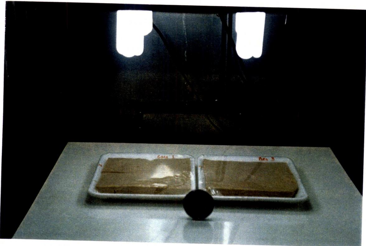
Figura 2: Sistema utilizado para exposição dos produtos à luz
