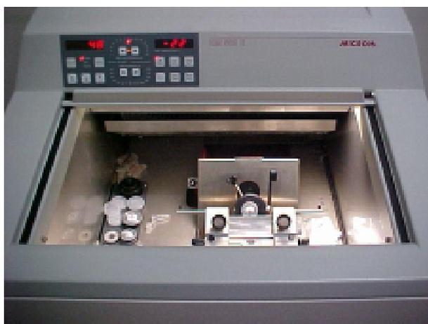
**Figura 8.** Micrótomo criostato - HM 505 E Microm com blocos de tecido muscular fixados.
