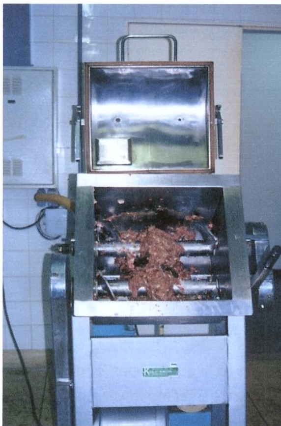
Figura 28 – Misturador (KLEBER ENGINEERING) utilizado nas etapas de mistura e homogeneização da massa antes do embutimento.
