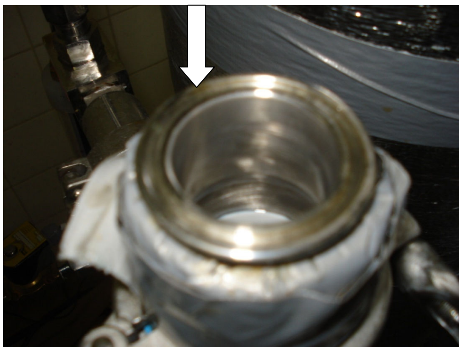
Figura18. Localização da posição da borracha de vedação da figura anterior
