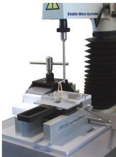
**Figura II-5 - Texturômetro acoplado com a sonda SMS/Kieffer para análise de micro-extensão de massas de farinha de trigo.**
