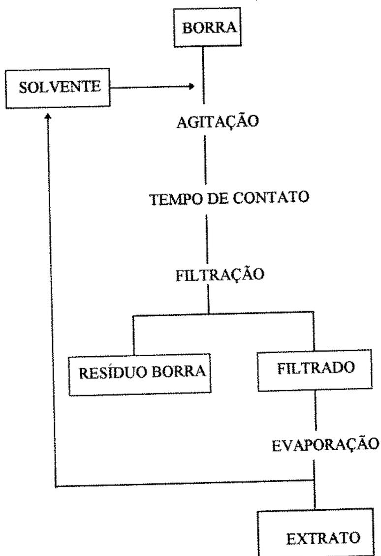
**Figura 10** : Fluxograma do processo de extração de  $\gamma$ -orizanol a partir da borra.
