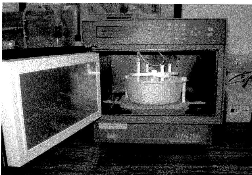
Figura 3 – Forno Digestor a Microondas CEM – Mod. MDS – 2100 (Adaptado)
