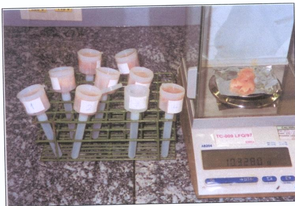
Figura 4 – Preparo das amostras para análises de capacidade de retenção de água: etapa de pesagem inicial.
