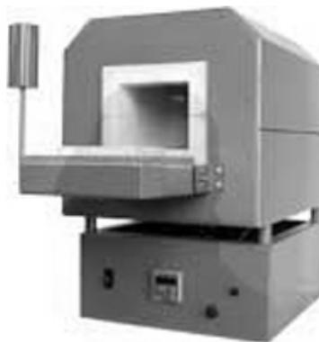
**Figura 4.2** - Mufla utilizada para a determinação do teor de cinzas.
