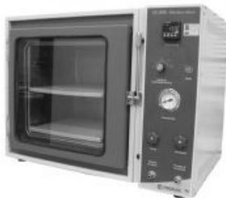
**Figura 4.1** - Estufa à vácuo utilizada para a determinação da umidade.
