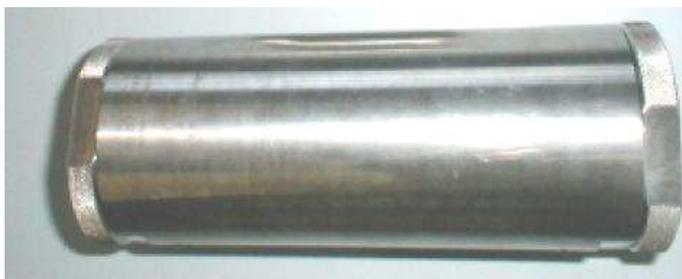
**Figura 4.5** - Célula de extração de 290mL (Thar Designs, CL 1373, Pittsburg, EUA).
