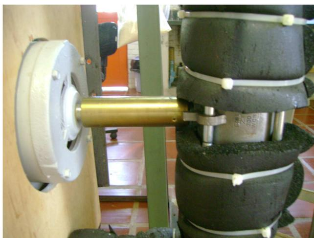
**Figura 3.9:** Fotografia do sistema de pulsação com válvula esfera.
