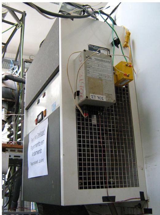
**Figura A.2:** Vista traseira da câmara frigorífica de estocagem, mostrando a unidade frigorífica *plug-in*, o transdutor de corrente e o transformador de corrente.
