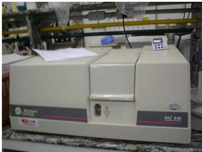
**Figura 09 – Equipamento utilizado na leitura das amostras – Espectrofotômetro.**
