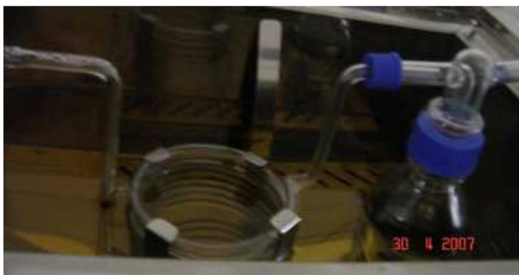
Figura 4.9. Serpentina e armadilha de vapor imersas no banho de óleo sintético.
