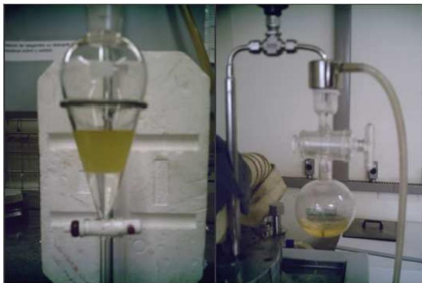
Figura 4.11. Funil de separação contendo a fase aquosa e oleosa do destilado/ Balão coletor de amostra após o experimento.
