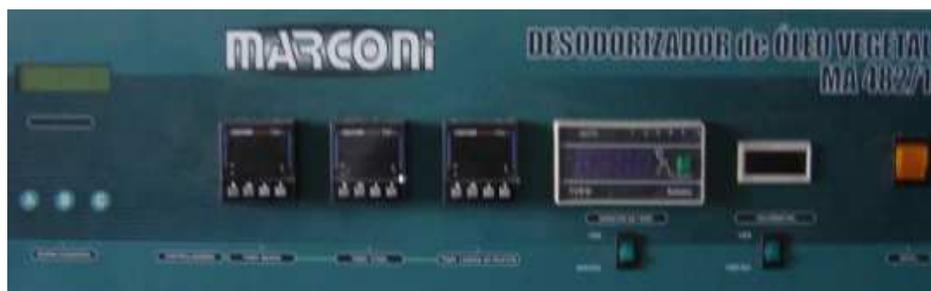
Figura 4.6. Painel de controle do desodorizador
