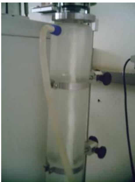
Figura 5.2. Amostra volatilizada recolhida no condensador durante experimento do sistema-modelo A, antes da injeção de vapor.
