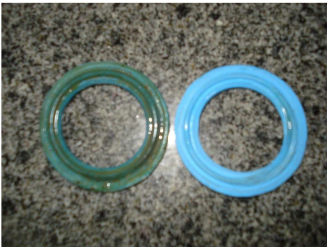
Figura 4.17. Contaminação do o-ring da válvula da bomba (defeito na vedação).
