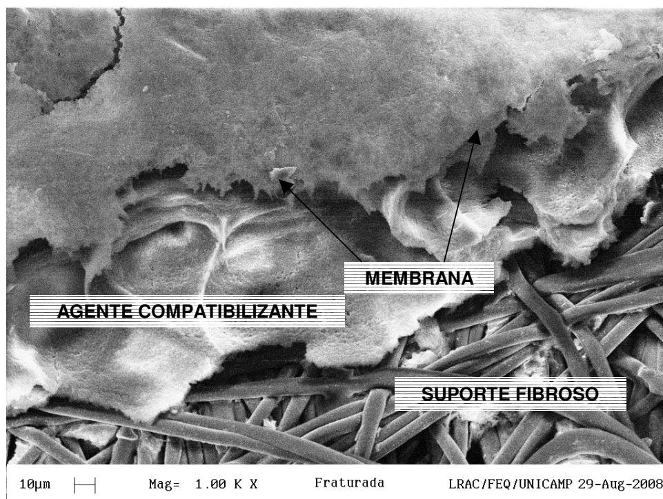
Figura 5.19: Detalhe do polímero e suporte da membrana de PVDF de 500 kDa.
