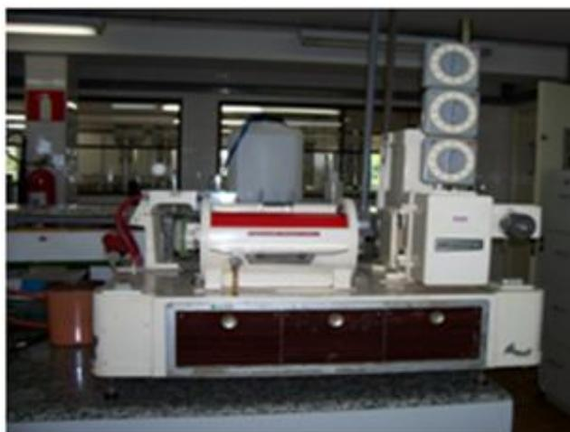
Figura 1.5 – Extensógrafo, marca Brabender
