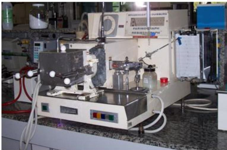
Figura 1.4 – Farinógrafo, marca Brabender
