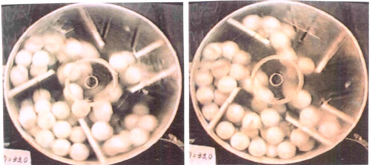
Figura 4.5. Vistas da distribuição do leito de esferas de cerâmica para duas posições do cilindro a 33,0rpm, com 4 aletas de 70° e 0,059m de largura, e leito com  $z=0,08m$ .
