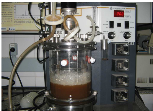
(1) Fermentação e centrifugação do meio de cultivo para obtenção de massa celular
