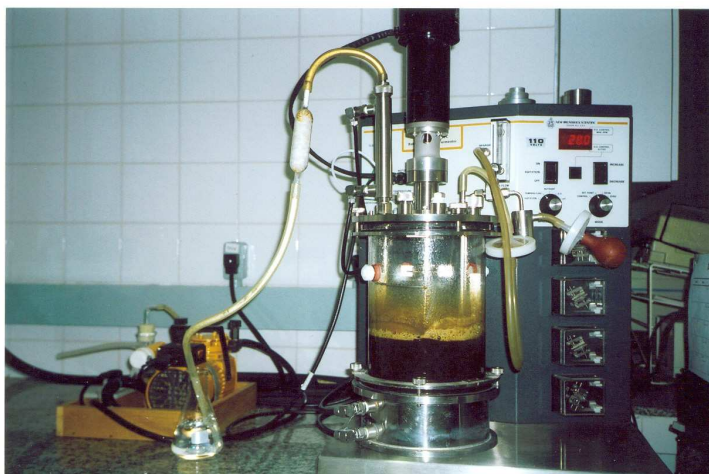
Figura 3.1: Ilustração do fermentador de 6,6 L Bioflow IIC.
