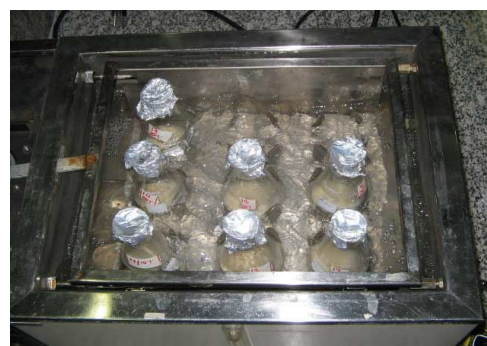
(2) Ensaio com células livres e substrato sacarose em banho-maria com agitação
