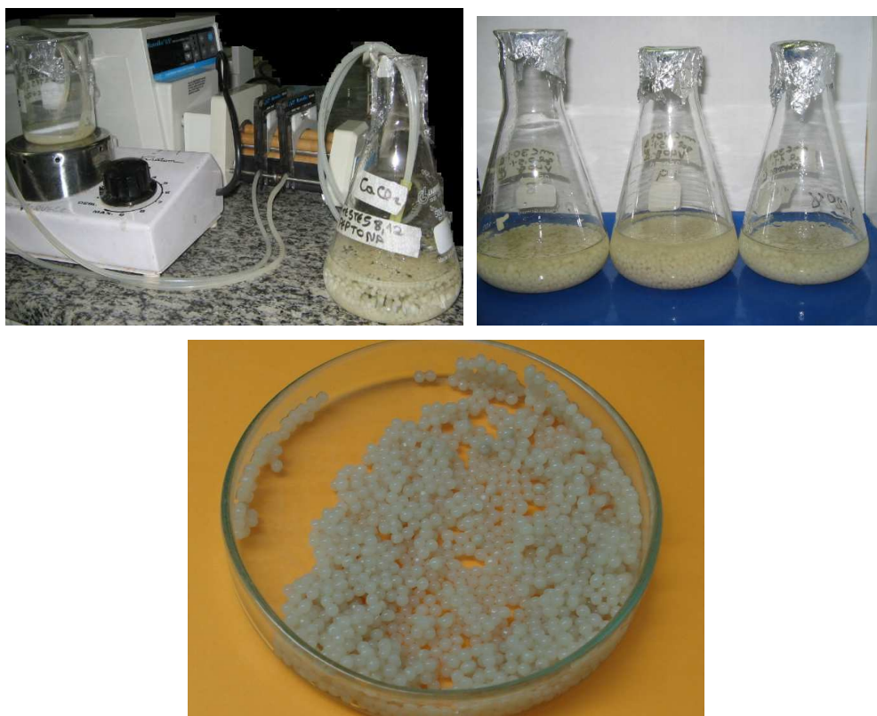
Figura 5.3: Técnica de imobilização das células de Serratia plymuthica em alginato de cálcio.
