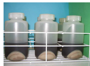
(1) Fermentação e centrifugação do meio de cultivo para obtenção de massa celular
