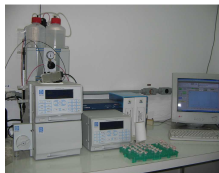
(3) Análise dos carboidratos em cromatógrafo Dionex®
