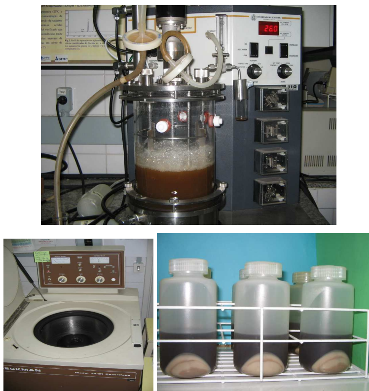
Figura 5.2: Fermentação e centrifugação do meio de cultivo para obtenção de massa celular da bactéria Serratia plymuthica .
