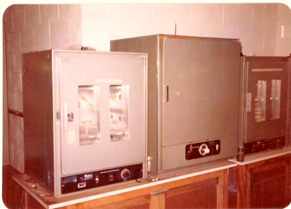
FIGURA 4. Estufa ( ao centro ) utilizada para as determinações do teor de umidade das se mentes. Câmara ( à esquerda ) usada pa ra o teste de vigor.
