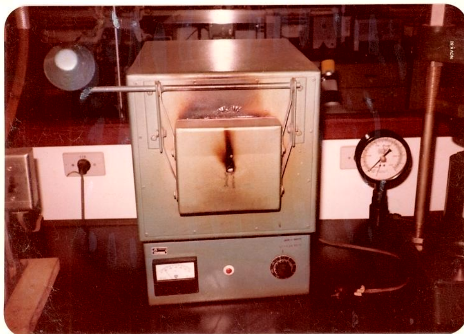
FIGURA 5. Mufla para determinação do teor de cin za das sementes.
