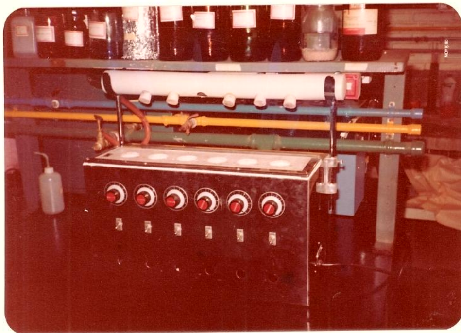
FIGURA 3. Digestor usado para a determinação do teor de proteína das sementes de soja.
