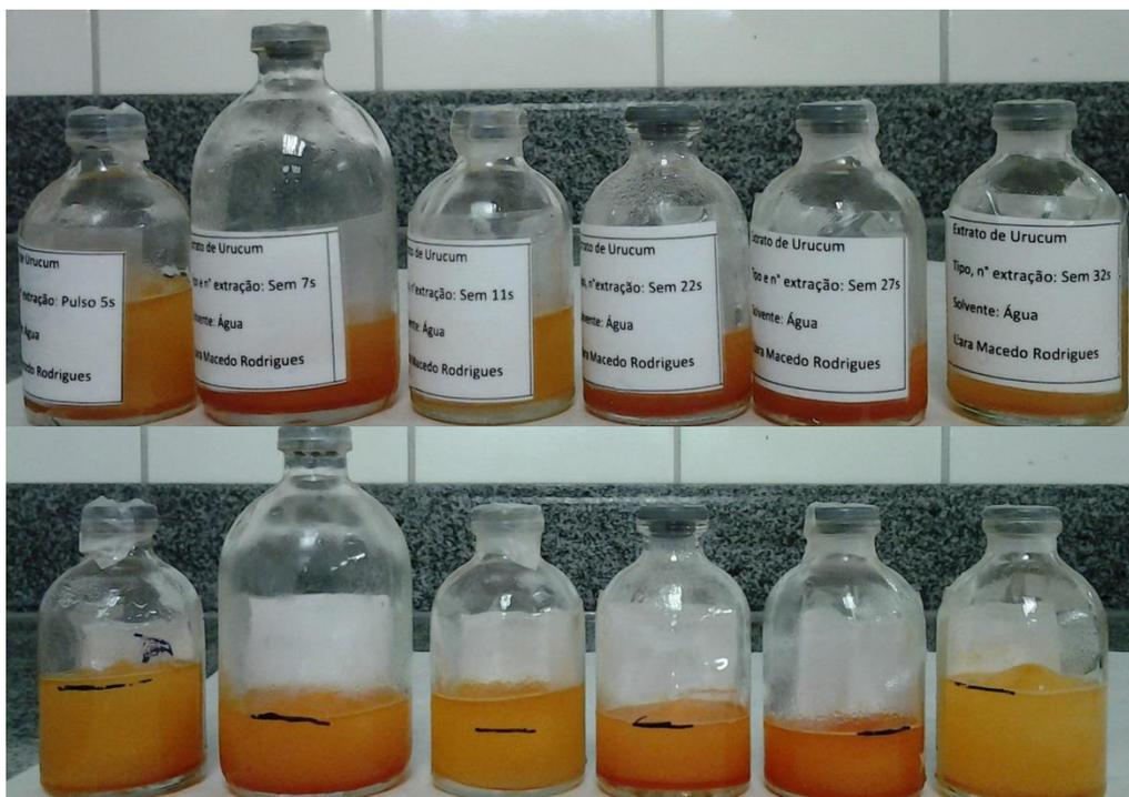
Figura 9. 6 – Extratos de Urucum obtidos com água à baixa pressão, com diferentes S/F e temperaturas.
