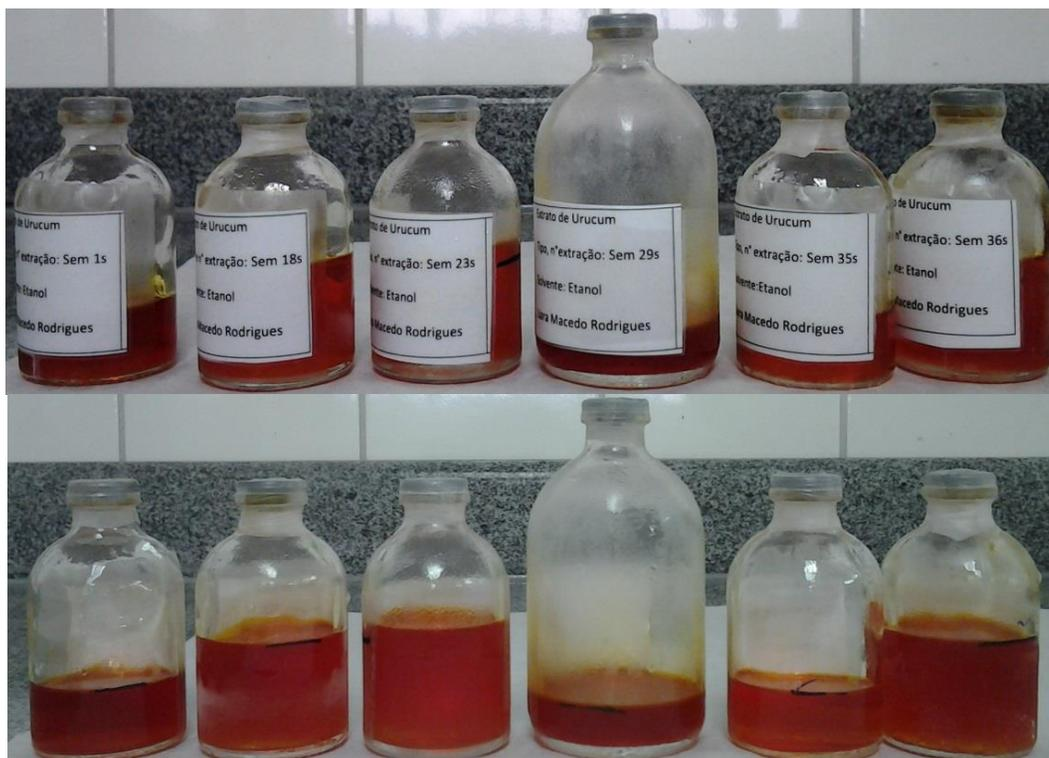
Figura 9. 9 - Extratos de Urucum obtidos com etanol LPSE à baixa pressão, em diferentes S/F e temperaturas.
