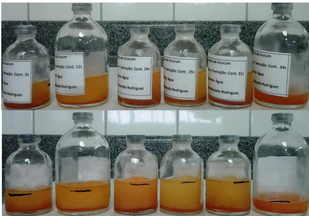
Figura 9. 8 - Extratos de Urucum obtidos com água LPSE-C a baixa pressão assistido por ultrassom em toda extração, em diferentes S/F e temperaturas.
