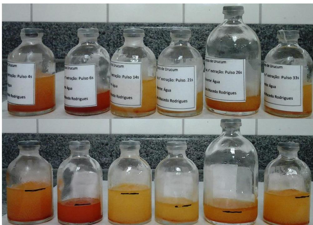
Figura 9. 7 - Extratos de Urucum obtidos com água LPSE-P a baixa pressão assistido por ultrassom em pulsos, em diferentes S/F e temperaturas.
