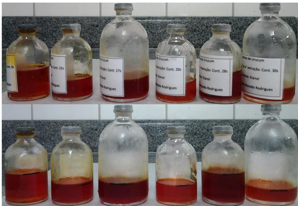
Figura 9. 11 - Extratos de Urucum obtidos com etanol LPSE-C à baixa pressão assistido por ultrassom durante toda extração, em diferentes S/F e temperaturas.
