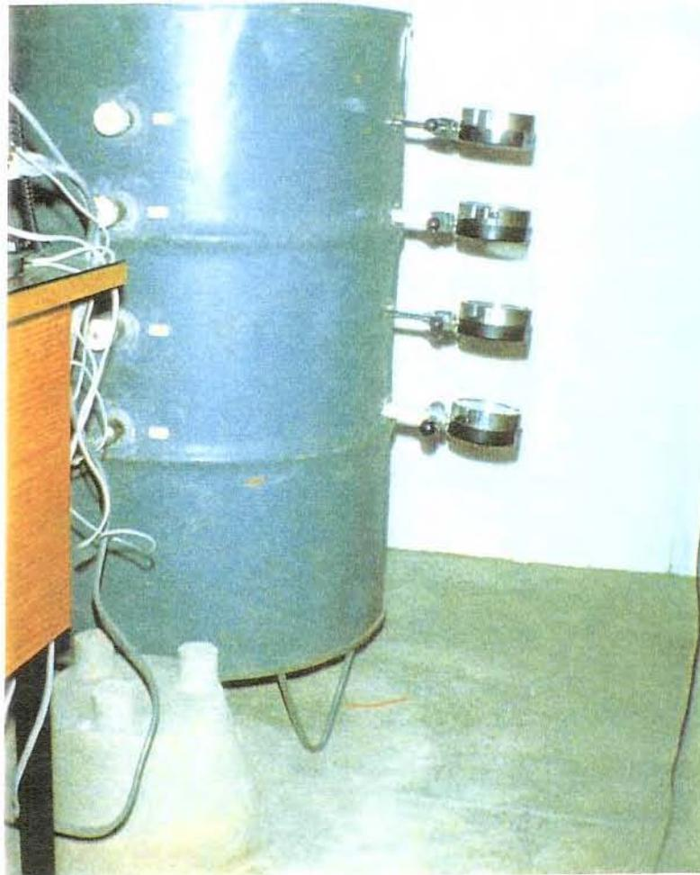
FIGURA 4.5 - Higrômetros de espada para determinação da umidade relativa do ar de secagem nas 4 seções do secador de camada estacionária.
