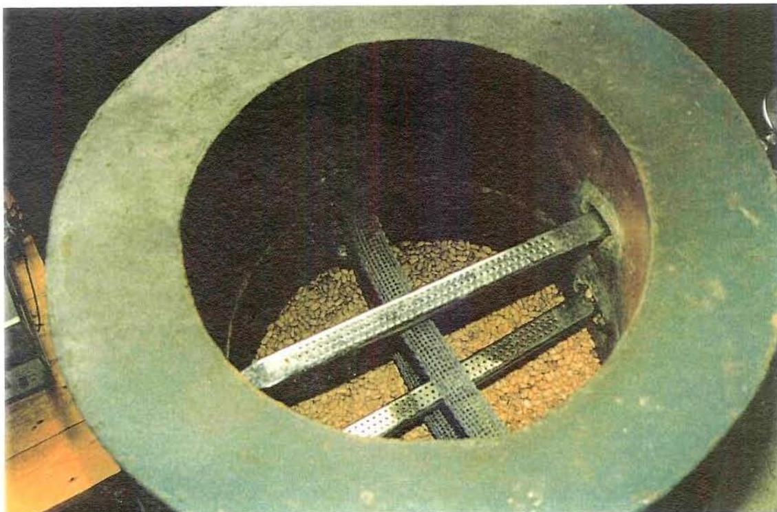
FIGURA 4.6 - Detalhes internos da câmara de secagem do secador de camada estacionária.
