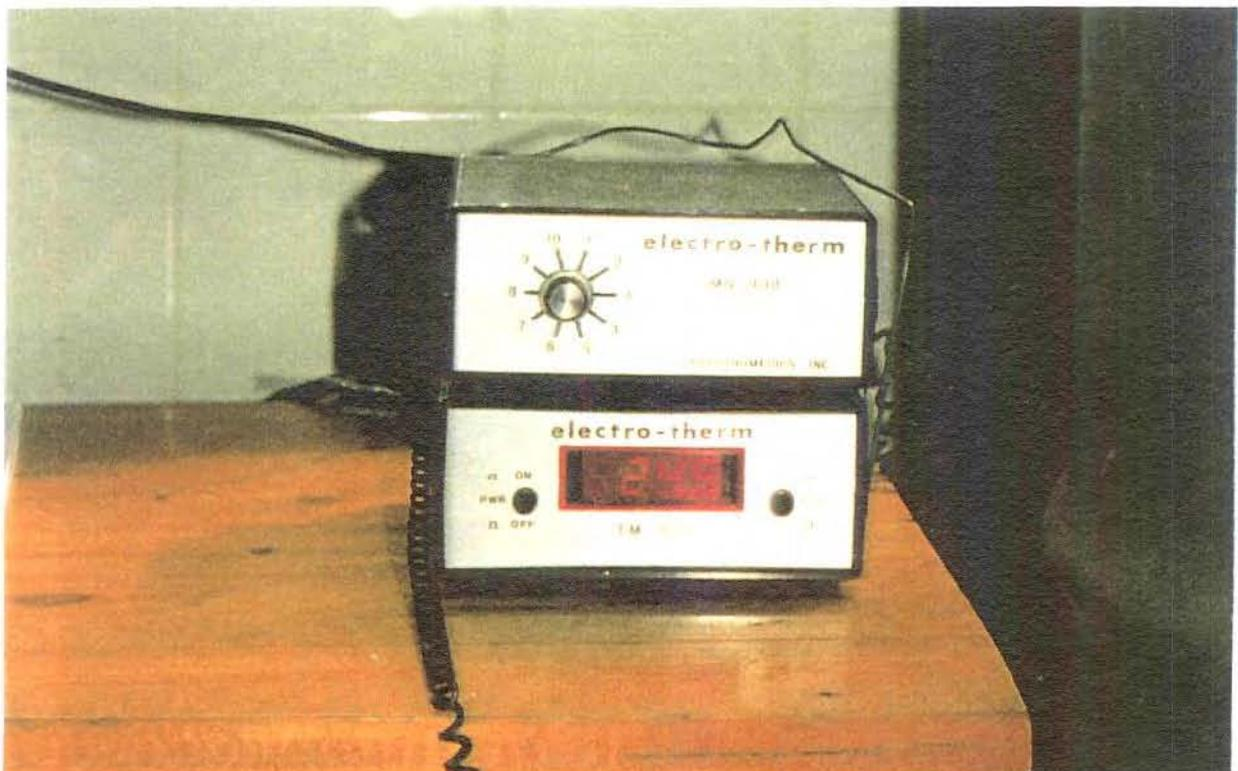
FIGURA 4.4 - Aparelho de medição de temperatura de 10 canais Electro-Term MS-800.
