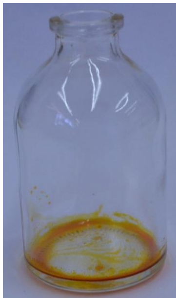
Figura 25 – Extrato de pimenta variedade malagueta obtido com dióxido de carbono supercrítico a 15 MPa, 40 °C e uma vazão de solvente de 1,673 \times 10^{-4} kg/s, com ultrassom (360 W a 60 minutos) para o diâmetro médio de partícula.
