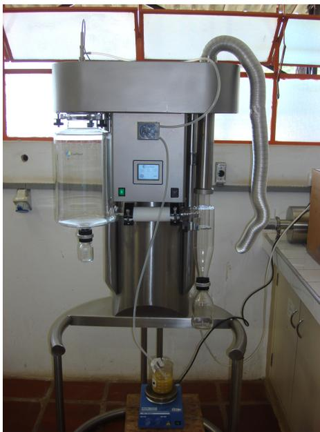
Figura 4.4: Spray dryer utilizado nos ensaios de secagem
