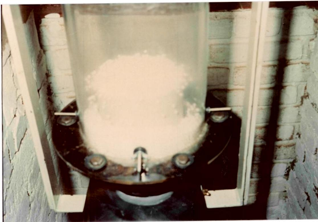
Figura III-3 . Vaso de secagem com o leito formado por partículas de sagú sub-
