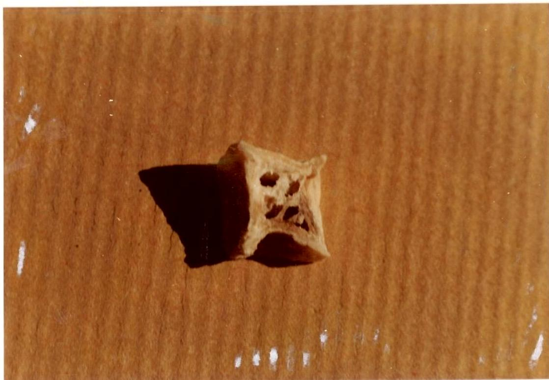
Figura V-7 . Partícula com uma face seccionada, mostrando a formação de múltiplas cavidades internas.
