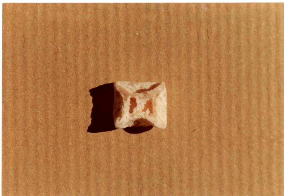
Figura V-6 . Partícula com uma face seccionada, mostrando a formação de duas cavidades internas.
