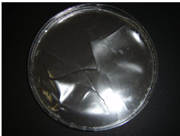
**Figura 4.13.** Rachaduras no filme de amido após o processo de secagem.
